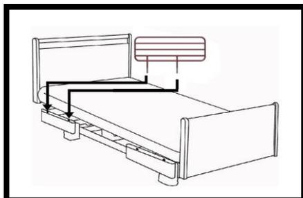
サイドレール挿し込み部をベッドサイドフレームのホルダー(穴)へ差込みます。
