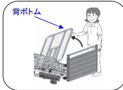
②背上げモーター先端のインシュロックを切って、Rピン及びピンを抜いてください。
