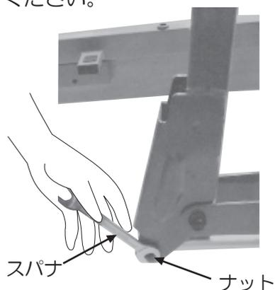
ボルトを抜く際は、モーター先端で床を傷つけない様に手で支えて作業してください
