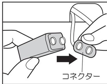
①非常用乾電池（市販のアルカリ乾電池9V形）の＋と－を正しくセットします。
