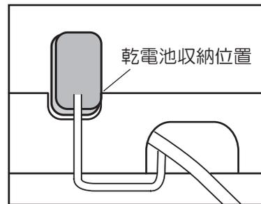
②非常用乾電池（市販のアルカリ乾電池9V形）をモーターユニットの乾電池収納位置に収納します。
