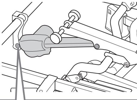
ここを斜めに押しながら、抜け止めスナップピンを取り外します。
