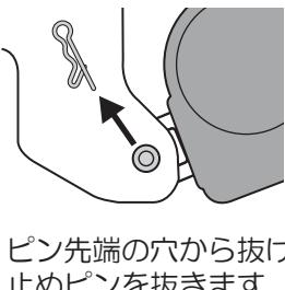
ピン先端の穴から抜け止めピンを抜きます。
