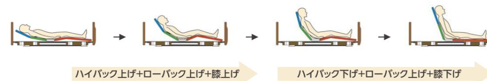
ハイバックは0°から最大20°、ローバックは0°から最大70°まで上がります。ハイバックとローバックの角度は合わせて最大70°を超えないように自動で調節され、腹部の角度が常に90°以上を確保するように設計されています。
