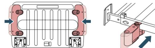
**モーター** モーターと手元スイッチの交換で、2モーターから3モーターへ変換できます。
