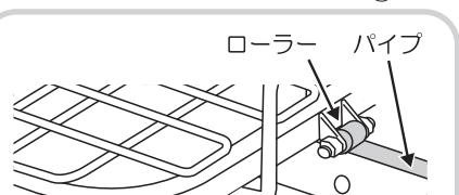
※フィッティングバーの切り換え後は、ローラーがパイプの上に確実に載っていることを確認してください。
