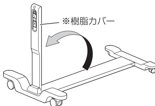
ベースフレームを支柱の裏側に載せ、水平を保ちながら六角穴付ボルト（黒）M8×15で2箇所をしっかりと締めてください。
