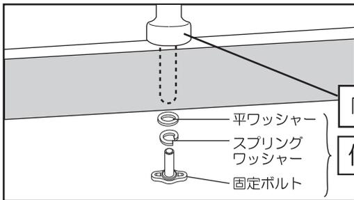
ベッド用グリップ差し込み部の下から、固定ボルトを取り付けます。その際、平ワッシャーとスプリングワッシャーを間に挟みます。
