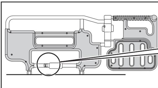
オレンジ色の本体固定用グリップを「しめる」方向に固くなるまで回してベッド用グリップを固定します。
