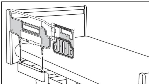
ベッド用グリップの差し込み部を、ベッドのホルダーの穴に差し込みます。
