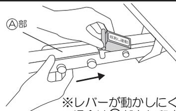
※レバーが動かしにくい場合はⒶ部を矢印方向へ押しながらレバーを動かしてください
