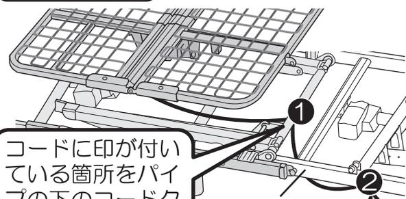
コードに印が付いている箇所をパイプの下のコードクリップ①に取り付けてください。
