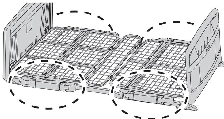
角度計は、ポジショニングベッドのハイバックサポート機能をご使用時、背ボトムのハイバック角度を計測する物です。図を参照し、適切な場所に取り付けてご使用ください。
