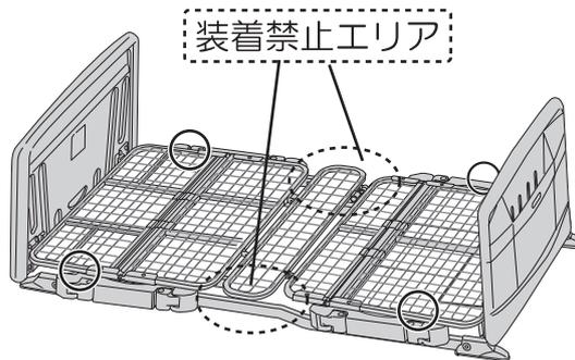
②図2のようにマットレスストッパーの奥まで、確実にフレームに取り付けてください
