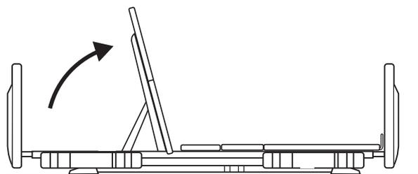
②背上げモーター先端のピンを外してください。
