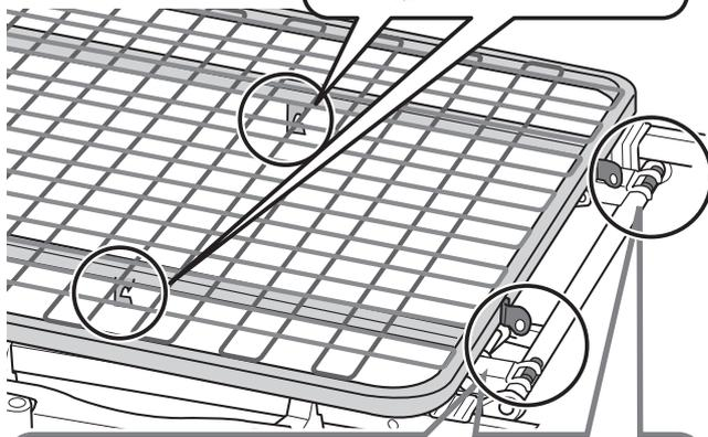
①背ボトムとヘッドフレームの取り付け部分を合せ、ピン(短)を挿し込み、ピンの穴に割りピンを挿し込みます。
