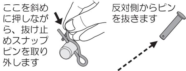
④背上げモーターをヘッドフレームから外します。
