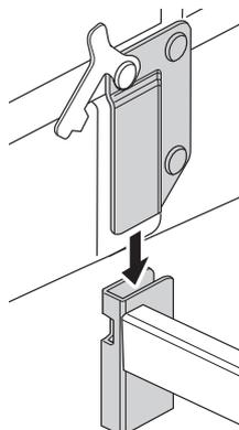
①ヘッドフレーム・フットフレームの取付金具に真上から挿し込みます。
