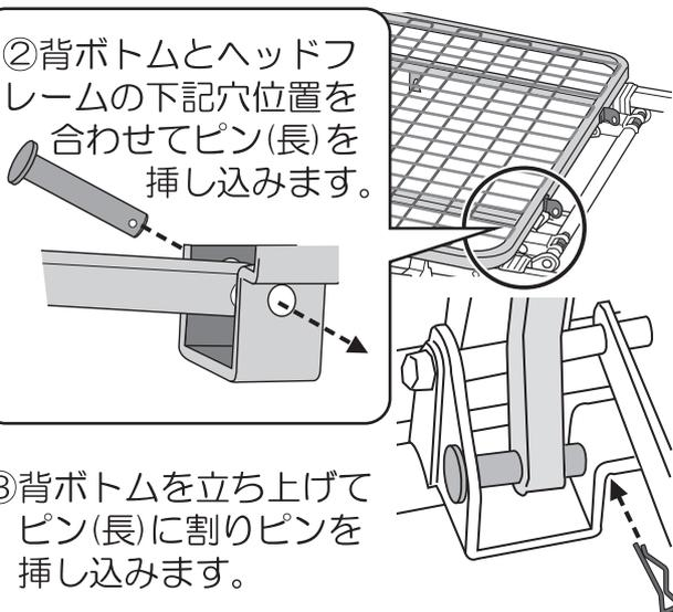
③背ボトムを立ち上げてピン(長)に割りピンを挿し込みます。
