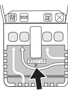
3 手元スイッチコードをスイッチ接続キット本体の手元スイッチ接続コネクタに挿し込みます。
