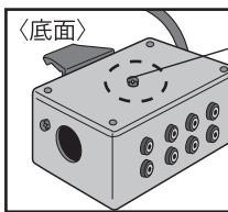
スイッチ接続キット本体底面の結束バンド固定具(各コード結束用)に付属の結束バンドを通し、コード類を束ねてください。手元スイッチや ECS、意思伝達装置用スイッチのコードの抜け防止としてもご使用ください。
