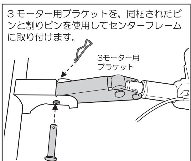
**△注意** ひざ上げモーターは、必ず下図の向きに取り付けてください。誤った向きに取り付けると昇降時に破損する恐れがあります。
