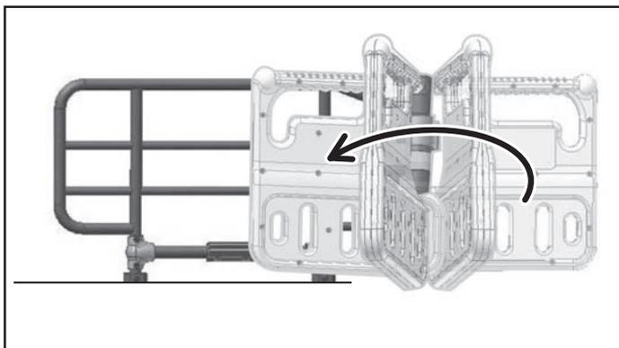
スイングアーム角度が、片側0°/45°/90°/135°（45°刻み片側4段階）に設定できます。使い勝手の良い角度に設定してお使いください。スイングアームをゆっくり回すと45°刻みで止まります。45°回ると解除ハンドルが上がり自動でロックされます。さらに回転させたい時は、ロックを解除してゆっくり45°づつ回転させます。
