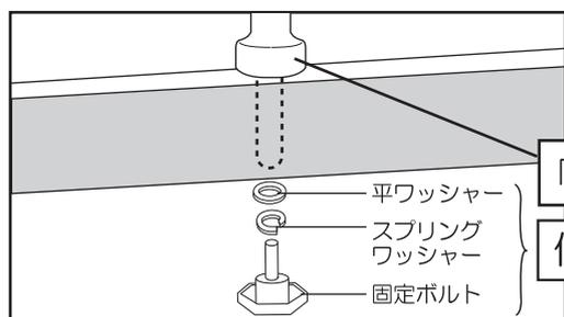
ベッド用グリップ差し込み部の下から、固定ボルトを取り付けます。その際、平ワッシャーとスプリングワッシャーを間に挟みます。
