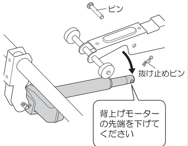
③背上げモーター根元側のピンと抜け止めピンを外してください。
