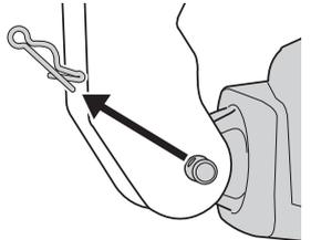
ピン先端の穴から抜け止めピンを抜きます。
