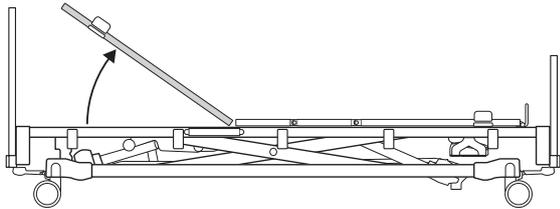
②背上げモーター先端の抜け止めピンとピンを外してモーターの先端を下げてください。
